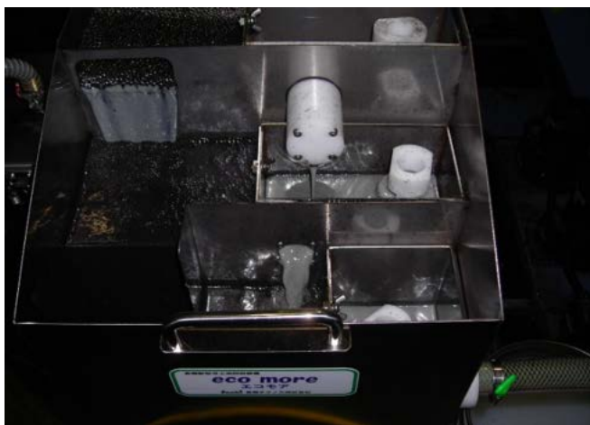
多段式分離槽
