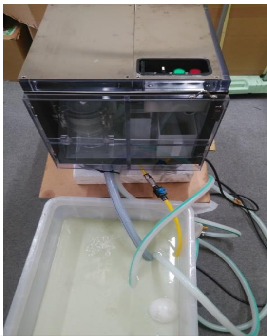
500X500X500コンパクト 全自動浮上油回収装置
