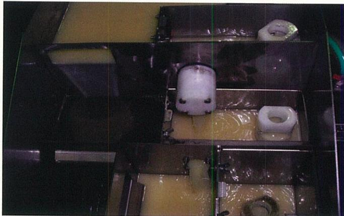
浮上油(浮遊スラッジ)と液を、Wスリット吸引ノズルで安定回収し、3段分離槽で効率よく分離します。
